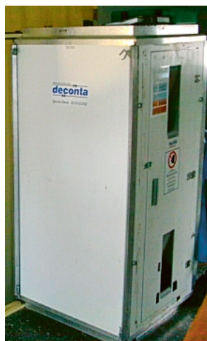
2 Accès à la zone de travail (sas, confiné)
