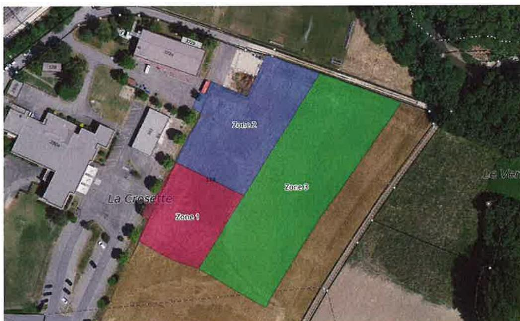
Figure 6 : Zones de décapage du projet selon les épaisseurs des horizons A et B.
