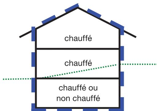
Lorsque tout le sous-sol est inclus dans l'enveloppe thermique du bâtiment, que l'isolation des parois et du toit est ininterrompue et que les fenêtres sont positionnées conformément à la page 15 et présente une valeur  $\Psi$  maximale de 0,15 W/mK, le justificatif des ponts thermiques est considéré comme établi.
