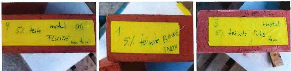
et de deux prototypes en grandeur nature sur une longueur d'environ 3m afin de contrôler les réactions des mélanges de bétons, fibres ferreuses, ferrailage et pigments ainsi que la qualité de finition suivant les procédés de moulage.
