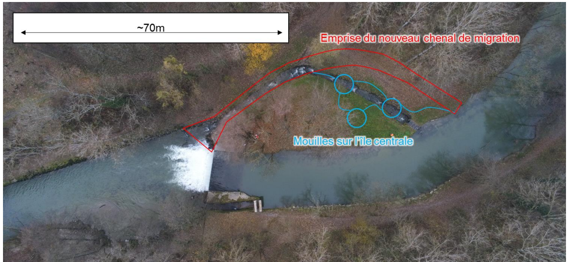
Figure 22 : Variante 4 : redimensionnement du chenal de migration existant - situation
