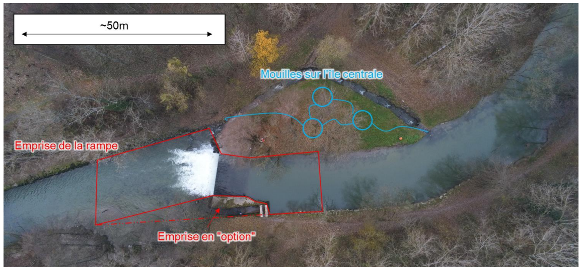
Figure 18 : Variante 2 : rampe rugueuse centrée sur le seuil - situation
