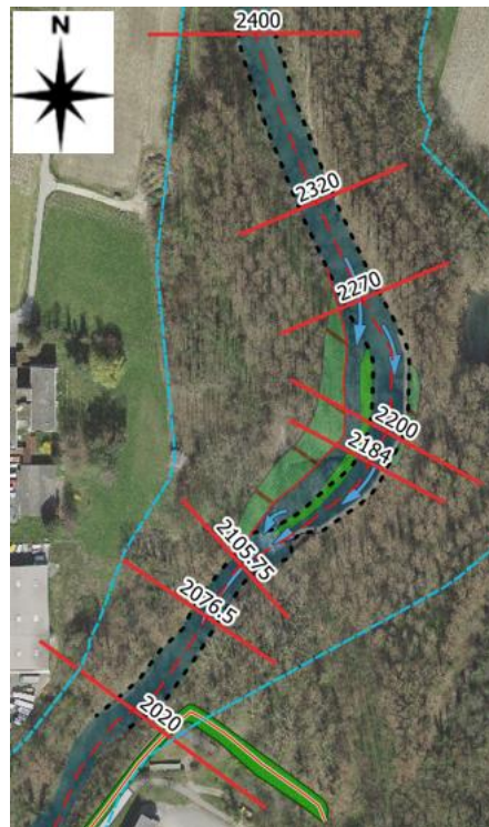
Figure 40 : Situation de l'emprise du chantier dans le cadre du remodelage du fond du lit lors des travaux de destruction du seuil O1.
