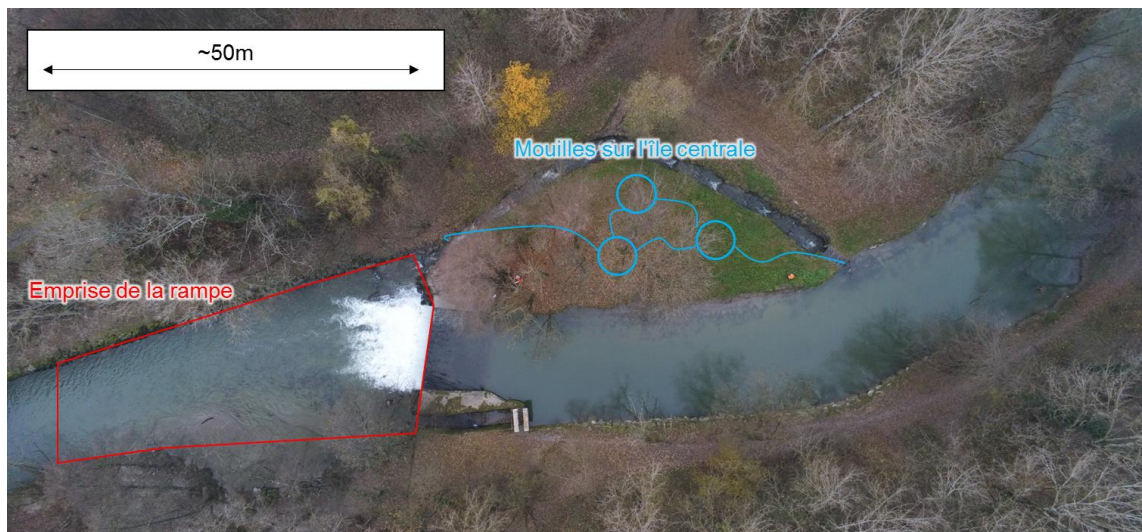
Figure 16 : Variante 1 : rampe rugueuse à l'aval du seuil - situation
